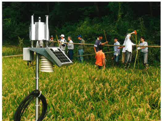
“NEC田んぼ作りプロジェクト”の一環として、田んぼを取り巻く気象条件をモニタリングするために設置した無線センサー。
